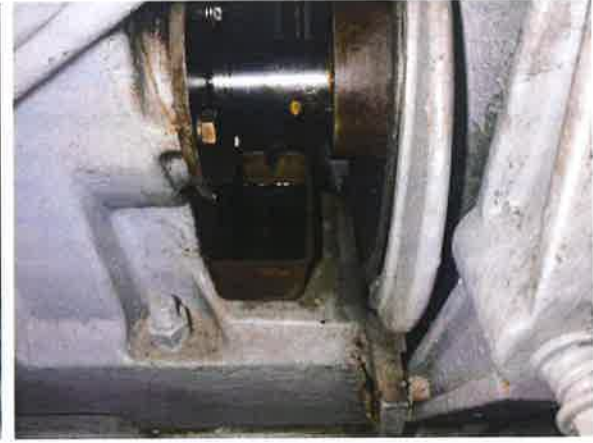
图 10：减速箱密封不良，存在渗漏油现象
