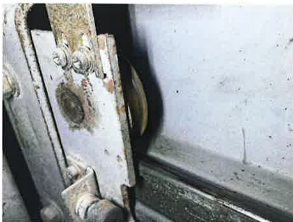
图 13：轿门门挂轮导向胶老化
