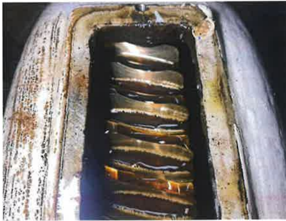
图 9：传动副啮合面未发现明显的啮合缺陷
