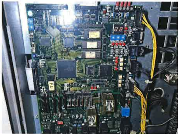
图 4：电梯主控电子板老化
